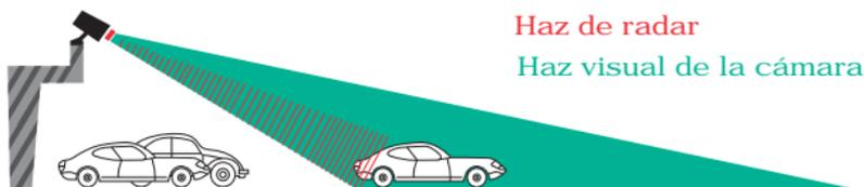
La condición de "haz" imposibilita por tanto que el radar pueda funcionar detrás de peraltes, esquinas u otros elementos opacos a las ondas de radio como metales.
